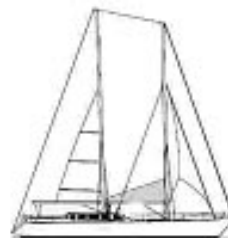
Bft. ab 12: Groß, 3. Reff Schoner mit Sturm- persenning Sturmklüver am Focktag Backstagen
